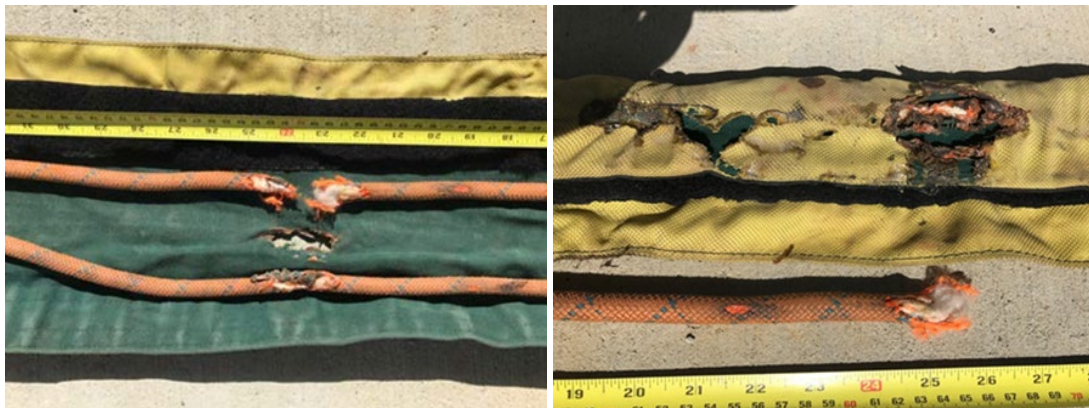
Figura 2: Cordas danificadas e protetor de corda
